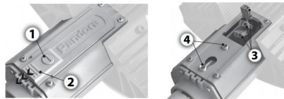
Рисунок 2. Схема установки светильника на кронштейн.
